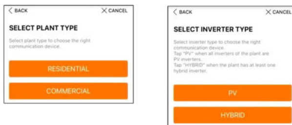
figure 6-3 Sélection du type d'installation/onduleur
