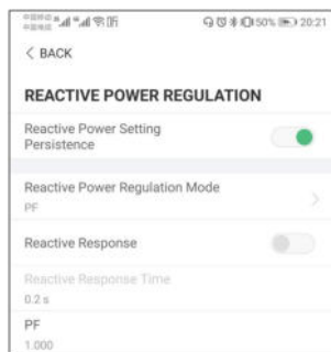
figure 7-18 Régulation de la puissance réactive
