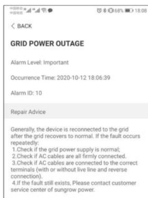
figure 7-9 Informations détaillées sur l'alarme de défaut
