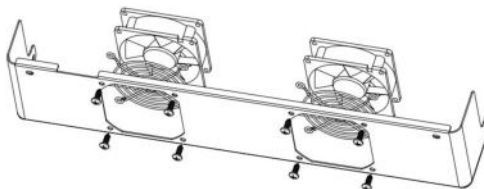
Figure 8-2 : retirez le ventilateur et le capot de protection
