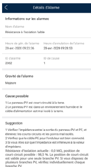
Figure D-1 Détails d'Alarme
